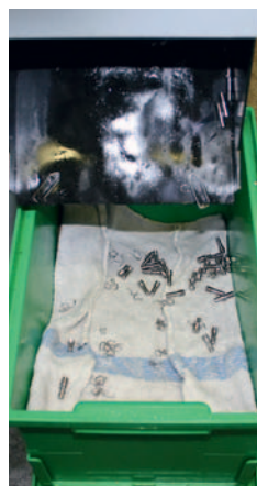
Die komplett bearbeiteten Teile werden über ein Transportband aus der Maschine befördert und fallen in fix und fertig in eine Box.
