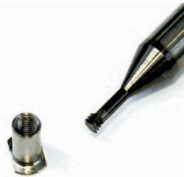
Fräsen von Innengewinden ist eine der Spezialitäten von Zerspanungstechnik Meister.
